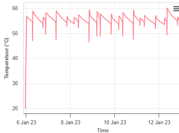
Figuur 5-7 Temperatuurverloop in het boiler vat zonder kloksturing
